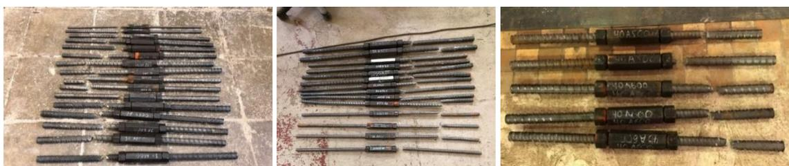
Рисунок 2 – Характер разрушения образцов
