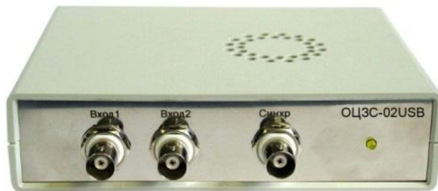
Рис.2.13 Внешний вид цифрового запоминающего осциллографа типа OЦЗС-02(100USB) ЗАО Руднев-Шиляев. [37]
