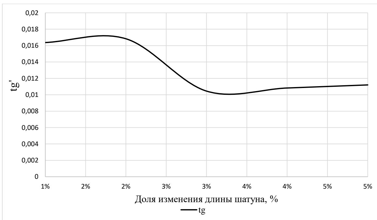
Рис. 3.69 Характер изменения значений показателя наличия неисправности \text{tg}'_{\text{max}} в зависимости от доли изменения длины шатуна 1-го цилиндра 6-ти цилиндрического ДВС.
