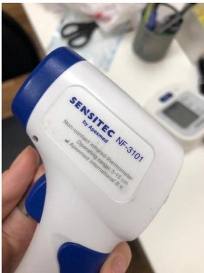
Рисунок 14. Аппарат дистантной термометрии
