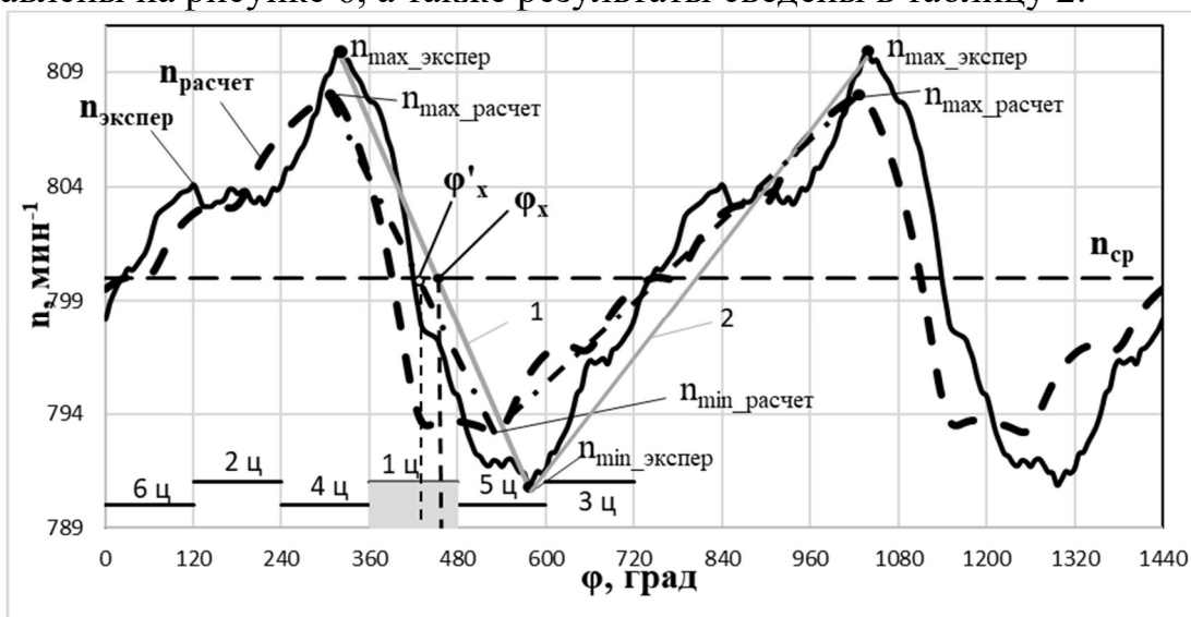
Рисунок 6. — сглаженная частота вращения (эксперимент), --- сглаженная частота вращения (расчет), 1 и 2 прямые, проходящая через точки максимального и минимального значения n_{\text{сглаж}}
