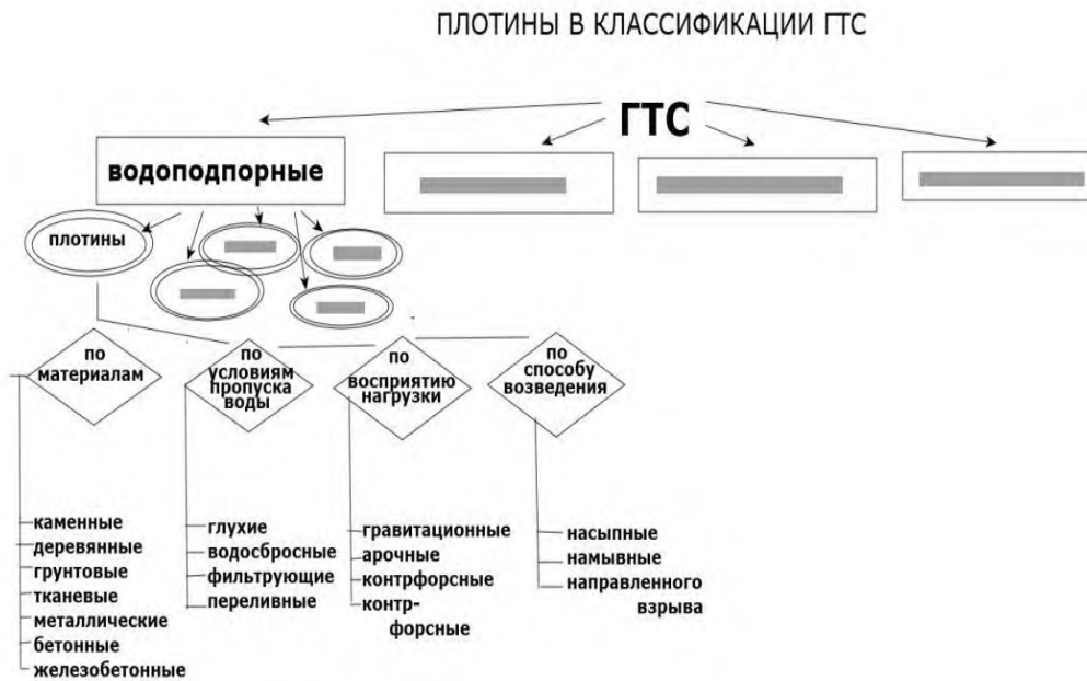
Рис. 2. Плотины в классификации гидротехнических сооружений
