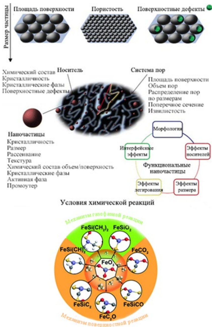
Рис. 4.17. Структурные изменения при уменьшении размера пористой подложки и металлических наночастиц и возможные механизмы дезактивации нанесенных металлических наночастиц
