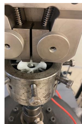
Рис. 3. Образец в процессе испытания условий вырывания
