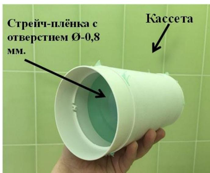
Рис. 17. Кассета ольфактометра с мембраной выполненной из тонкой стрейч-пленки, которую грызуны легко прорывают.
