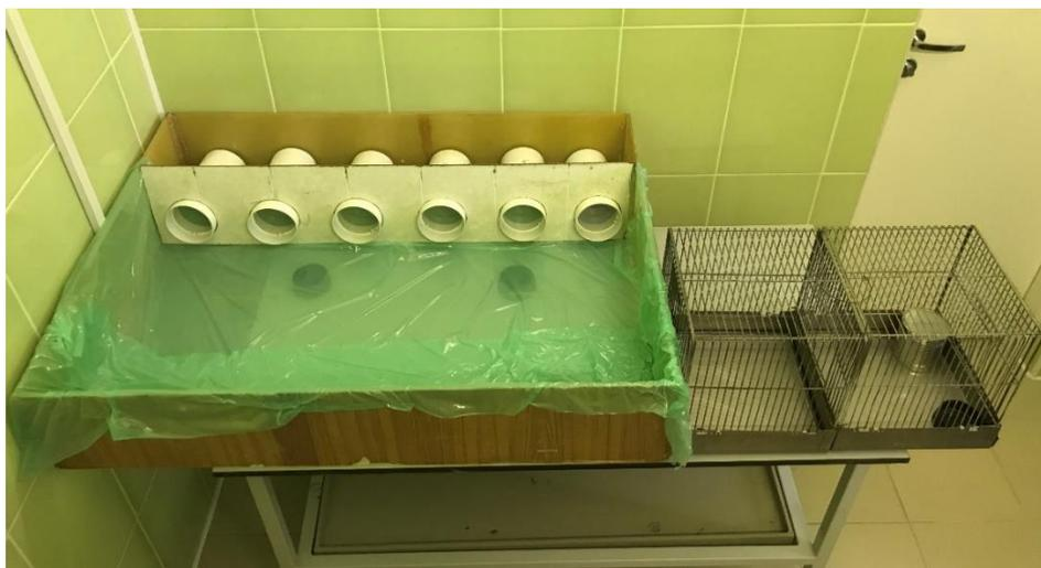
Рис. 16. Кассетно-мембранный ольфактометр в сборе
