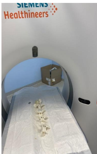
Рис. 3.2.1.2. Компьютерный томограф. Укладка имитаторов позвонков
