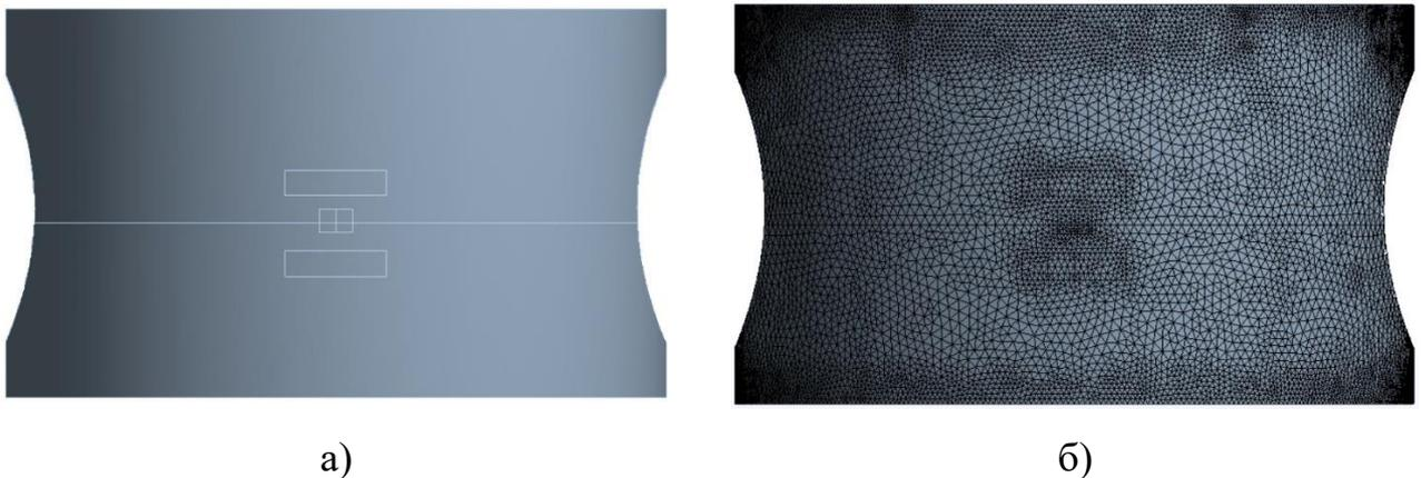
Рисунок 3.19 – Модели юбки поршня: а) твердотельная модель юбки поршня, с выделенными зонами установки тензорезисторов; б) конечно-элементная модель юбки поршня
