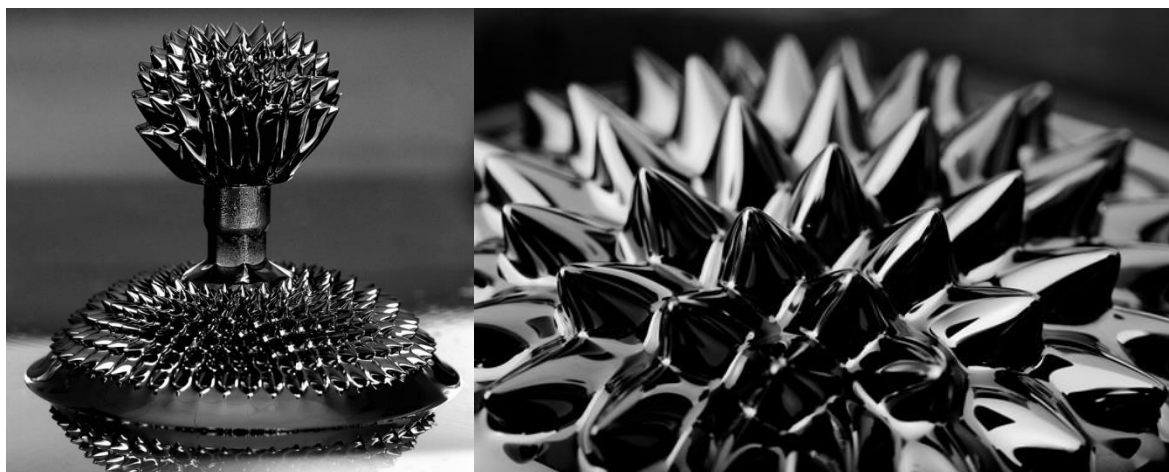
Рисунок 1.9 – Магнитно-реологическая жидкость под действием внешнего магнитного поля
