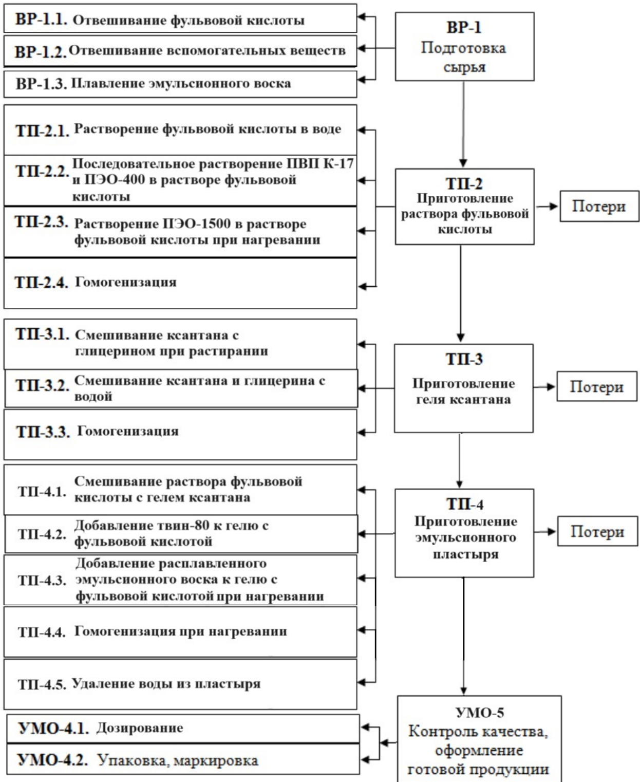
Рисунок 26. Технологическая схема приготовления трансдермального пластыря базового состава
