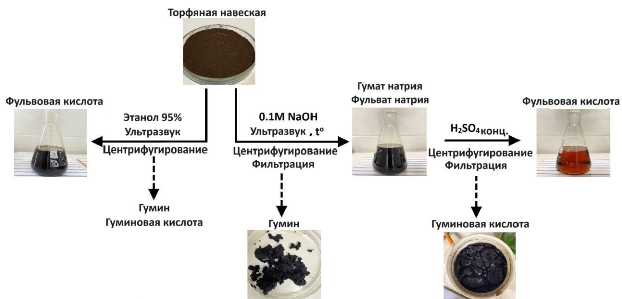
Рисунок 3. Схема выделения гуминовых производных (ГК и ФК) из торфа
