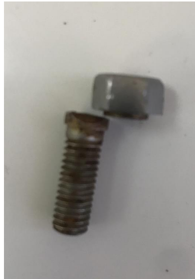
Рисунок 4.30 – Поломка спицефиксатора в процессе лечения
