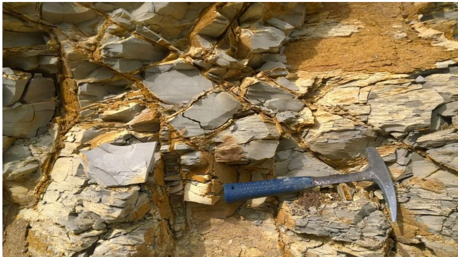
Рисунок 15 – Мергелистые глины майкопской серии, разбитые трещинами в котловане в районе ул. Волкова (г. Лермонтов) [161]
