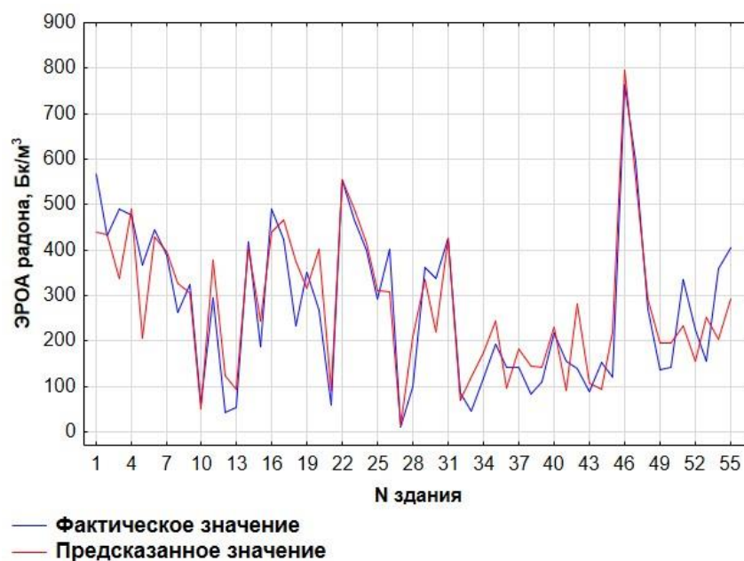
Рисунок 37 – Линейный график фактических и предсказанных по уравнению регрессии значений \text{ЭРОА}_{\text{Rn}} на 1 этажах зданий
