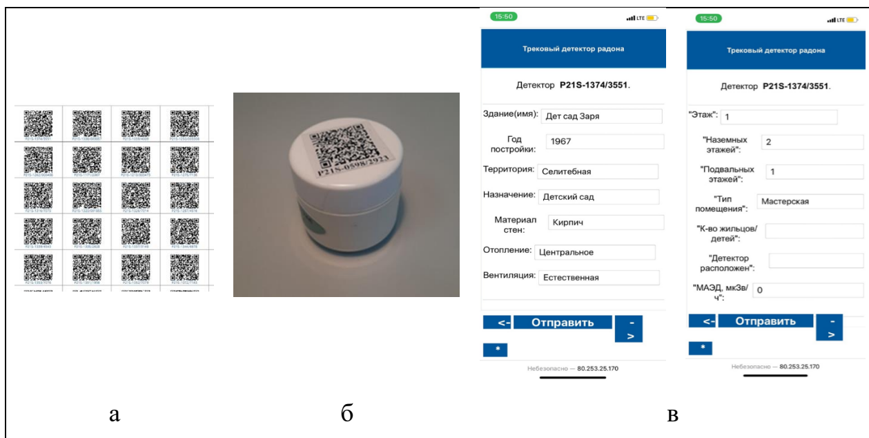
Рисунок 39 - Специализированное программное обеспечение «Радон-Lab»: а - вид страницы для печати QR-кодов; б – экспозиметр с наклеенным QR-кодом; в – пример записи информации об измерении на мобильном устройстве
