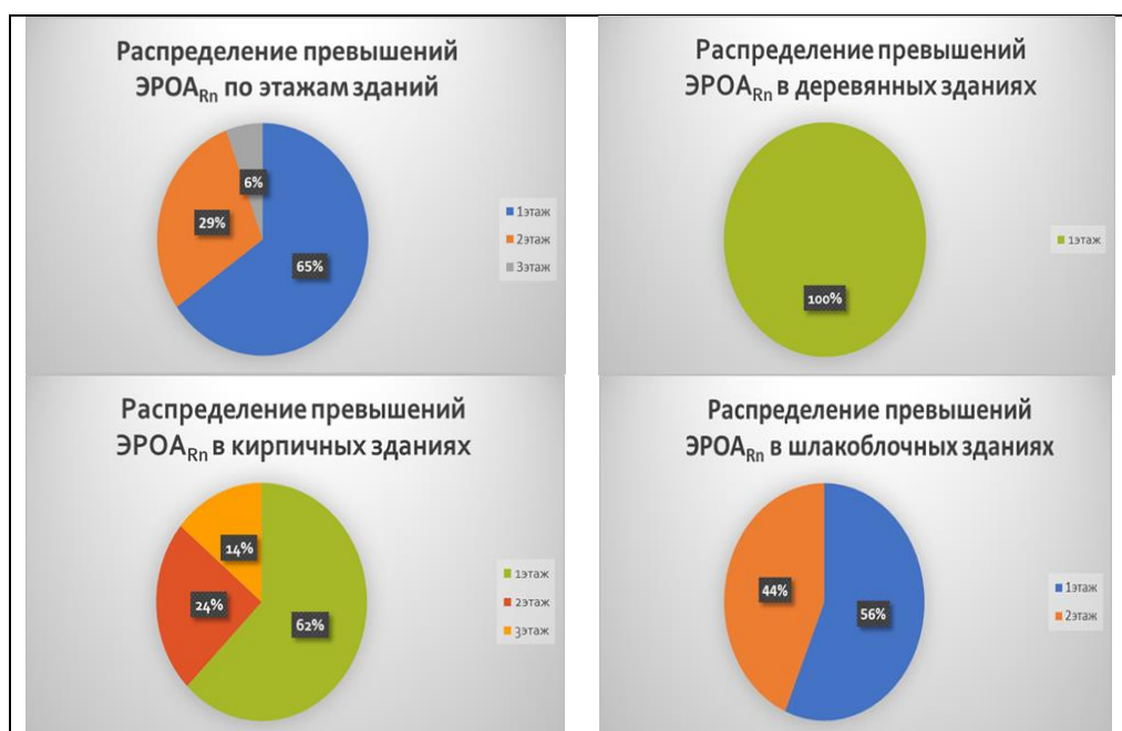
Рисунок 23 – Диаграммы распределения значений ЭРОА Rn выше 200 Бк/м 3 в помещениях зданий г. Балей в зависимости от этажа и строительного материала
